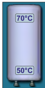
Akumulacijski spremnik sa prikazom gornje i donje temperature
