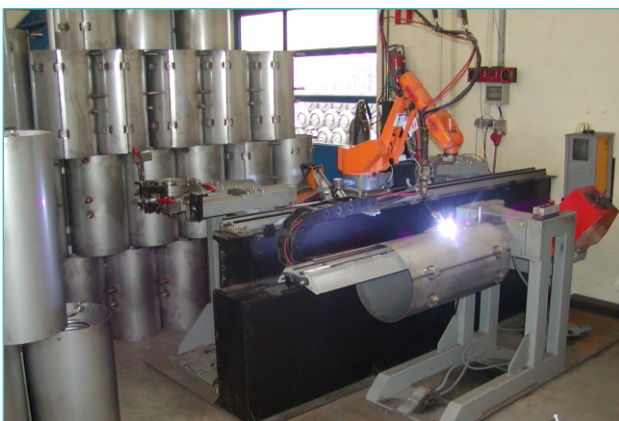
Robotsko zavarivanje bojlera od nehrđajućeg čelika
