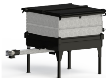
Prostorija/spremnik sječke sa mješačem spojenim na transporter
