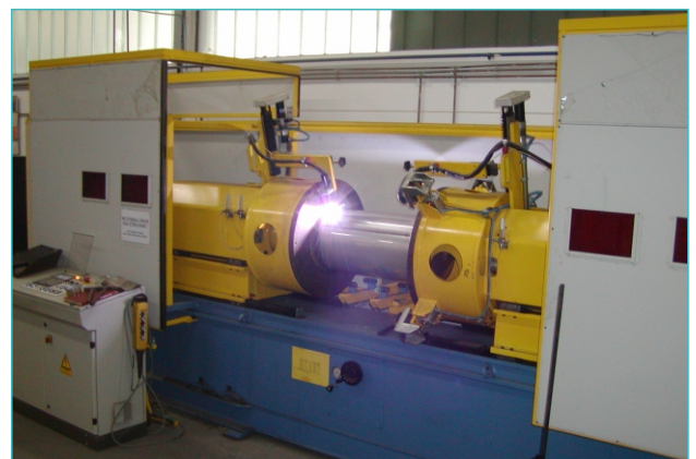
Automatsko zavarivanje bojlera od nehrđajućeg čelika
