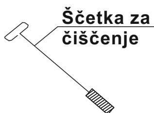
Slika 6. Oprema za čiščenje kotla BIO-PEK B
