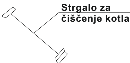
Slika 6. Oprema za čiščenje kotla BIO-PEK B
